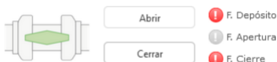
Ilustración 29. Válvula de hidrante abierta con fallo de depósito y fallo de cierre.
